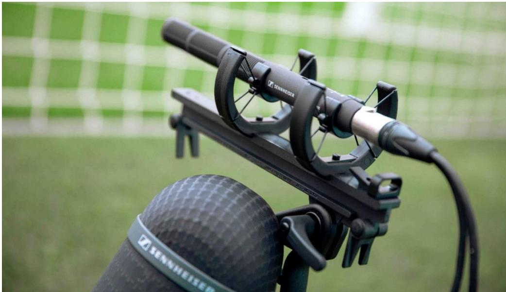
Le microphone canon stéréo Sennheiser MKH 8018 avec trois modes stéréo sélectionnables
