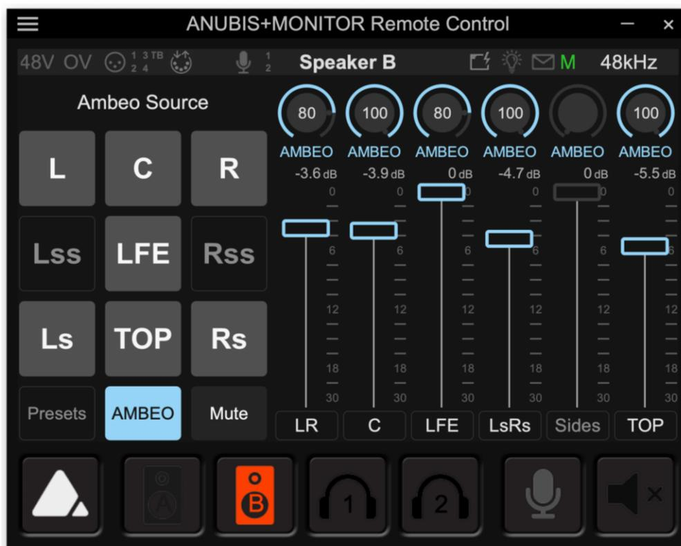
Le rendu audio spatial en direct AMBEO 2 canaux permet à tous les spectateurs de profiter pleinement des investissements réalisés dans les contenus surround et immersifs. La photo montre l'interface du rendu permettant de régler avec précision le mixage à deux canaux améliorés sur le plan spatial, contrôlé via le logiciel de commande à distance Anubis standard.
